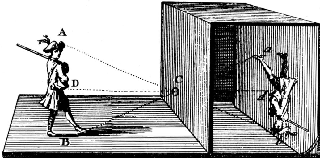
Illustration der Funktionsweise einer Camera Obscura (vermutlich 18. Jhd)
